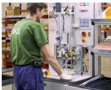
Vzduchový test na montážní lince.
